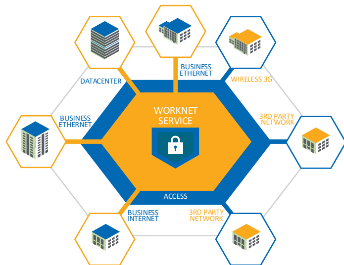
Im Worknet lassen sich verschiedene Standorte mit unterschiedlichen Access Technologien in ein gemeinsames sicheres Netzwerk einbinden.
